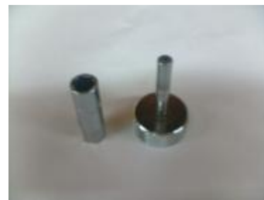
Pièces Pas. : 440662 Pièces Nom: Culasse AJUSTEUR D'ÉCARTEMENT DE VALVE
